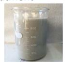
廃油 AOPplus処理後凝集沈殿
