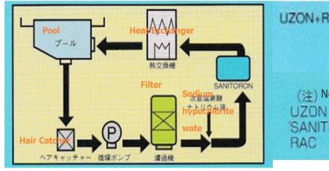
UZON+RAC (a) 主循環水処理法 (b) オーバーフロー水処理法 (a)Main Flow (b) Overflow water flow SANITRON+塩素 (注) Note Chlorine UZON 紫外線オゾン併用処理装置 UV and O3 terilizer SANITRON(H) 紫外線流水殺菌装置 UV sterilizer RAC 光分解装置 Photolysis equipment
